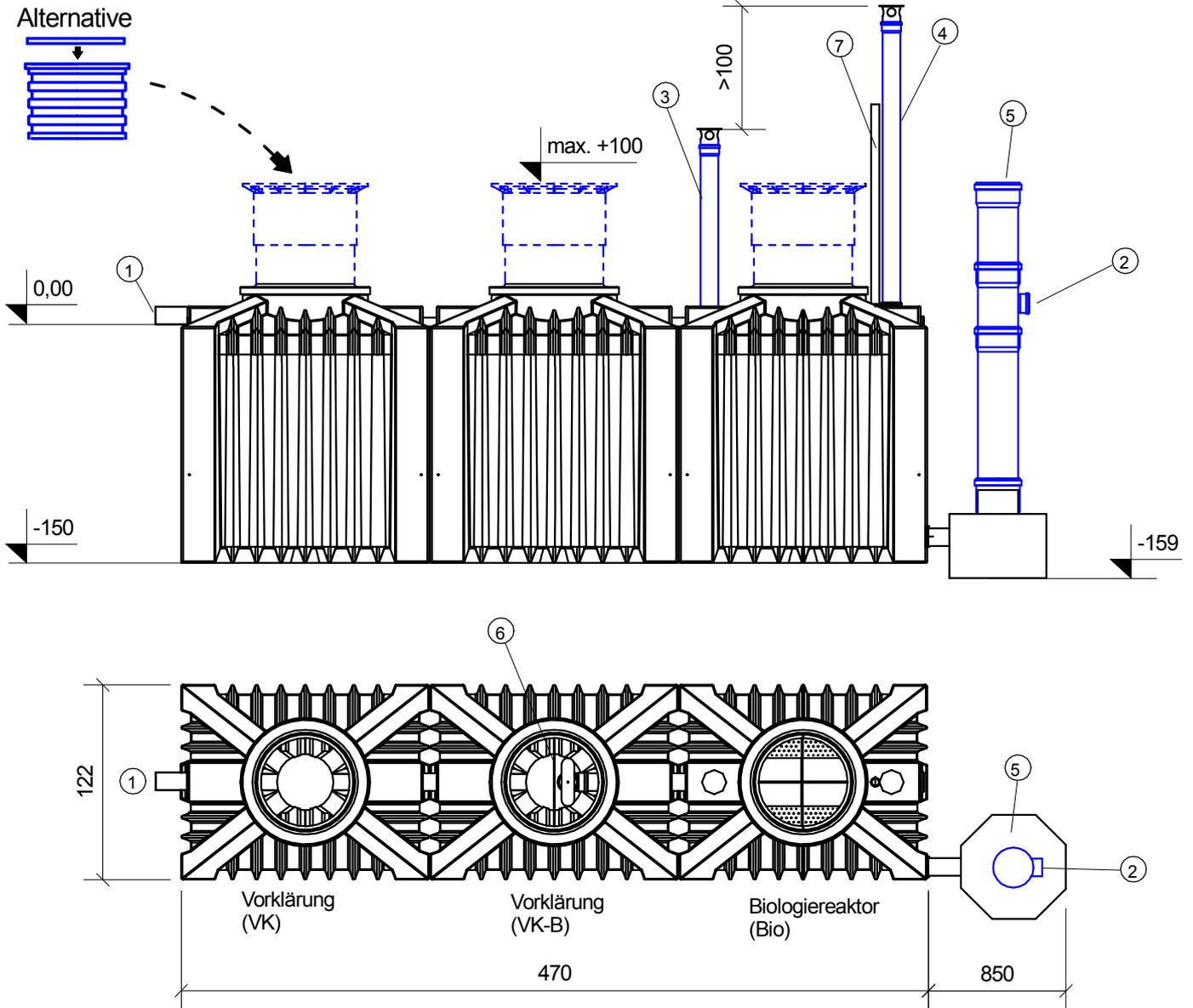
1. Zulauf DN100 ( $\text{\O}a=110\text{mm}$ ) (Mat. KG/PE)
